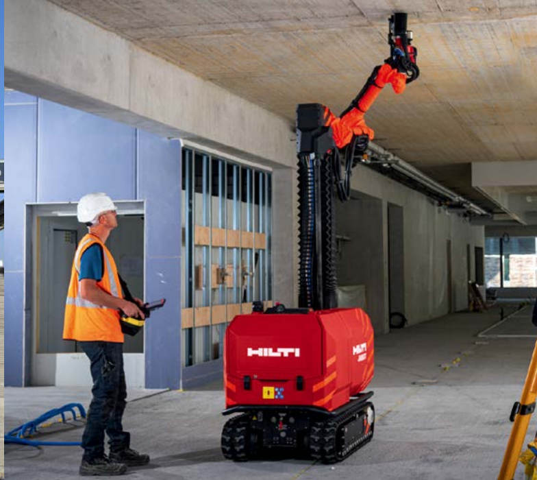
3.2.2: Jaibot – der semi-autonome, BIM-fähige Bohrroboter.
