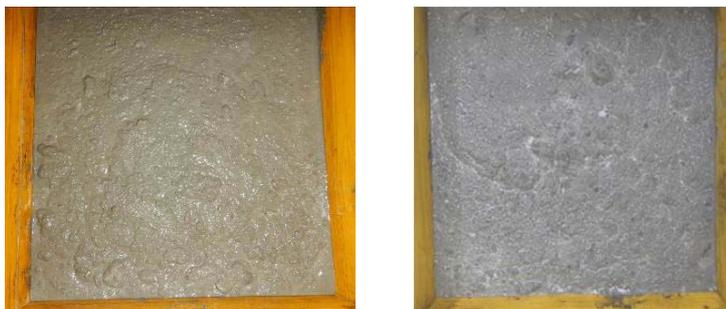
Abbildung 16: Unterbetonoberfläche direkt nach der Herstellung (links) sowie nach einer Wartezeit von 360 Minuten (rechts)
