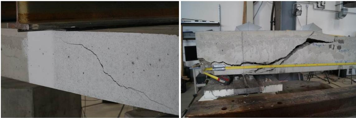
Abbildung 20: Rissentwicklung bei Platten mit NSC als Aufbeton
