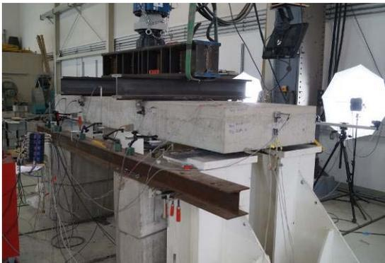
Abbildung 11: Teststand für die Großkörper
