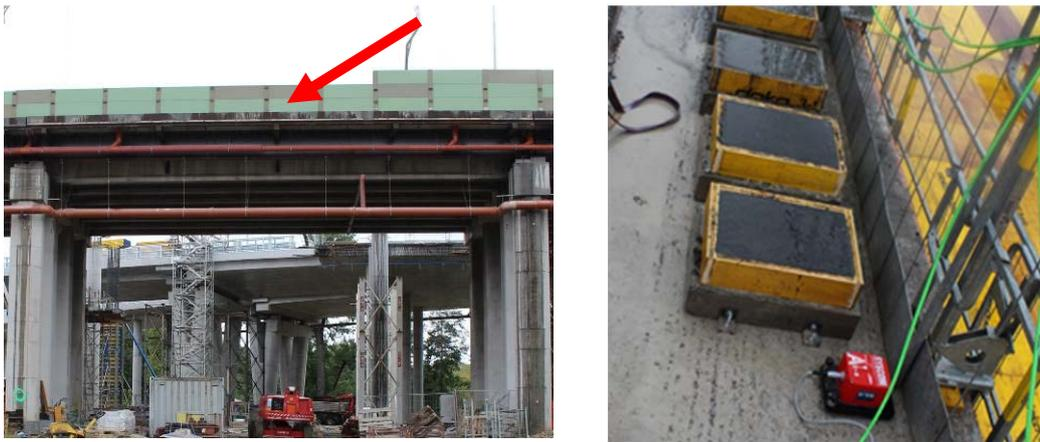
Abbildung 13: Tragwerk und Lagerungsposition der Probekörper mit Erschütterungsmesseinrichtung
