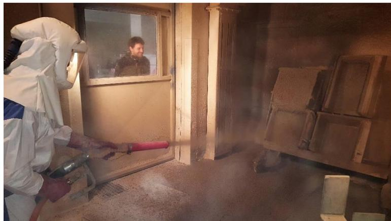
**Abbildung 5: Versuchsstand, Abstand Düse zu Kisten 2m; Neigung Kisten 13° gegen Vertikale**
