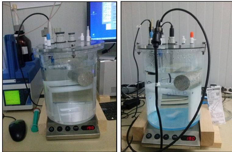
**Abb. 15: Experimenteller Versuchsaufbau zur Bestimmung des Auslaugerverhaltens von Spritzbeton bei leichtem Säureangriff. Links: Titration mit verdünnter HNO<sub>3</sub>. Rechts: kontinuierliche Zugabe von CO<sub>2</sub>. Die Entwicklung des pH-Wertes, der Temperatur und der spezifischen Leitfähigkeit wurde kontinuierlich aufgezeichnet.**
