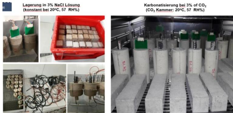
Abbildung 22: Lagerung der Proben in 3% NaCl (links) und in der Karbonatisierungskammer bei RH = 57%, T = 20°C und 3% CO<sub>2</sub> (rechts)
