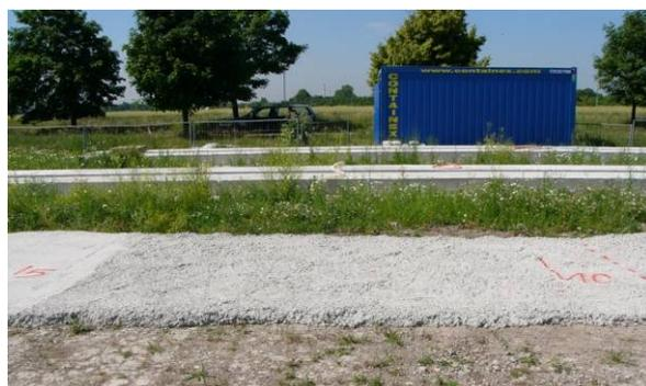
Abb.9: neue Sauberkeitsschicht mit unterschiedlichen Rauigkeiten
