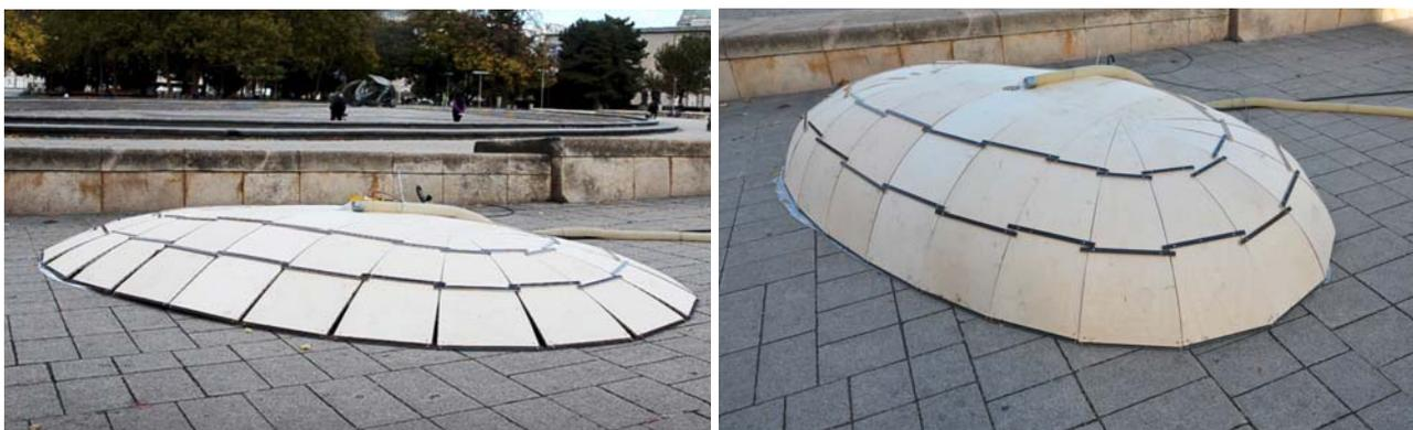
Abbildung 14 Vorversuch mit Holz-Mehrschichtplatten im Maßstab 1:5
