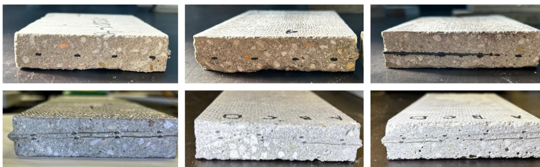
Abbildung 2.3.16: Schnittbilder: (oben) Carbon- und (unten) Basaltbewehrte Probenstücke
