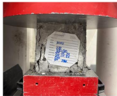
Abbildung 2.6.24: links: Druckfestigkeitsverläufe der Mischungen StF+BF TB1–TB3 nach 1, 7 und 28 Tagen, rechts: Bruchbild eines Würfels unter Druckbelastung
