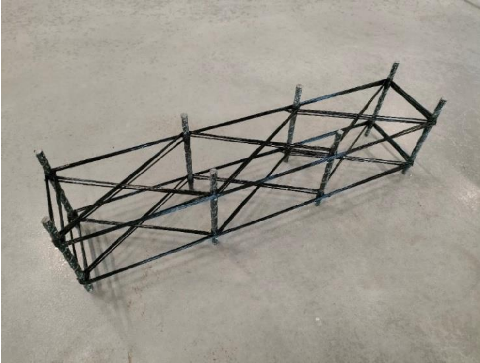
Abbildung 2.6.19: ein gewickeltes „3D-Fachwerk“ aus Basaltbündel
