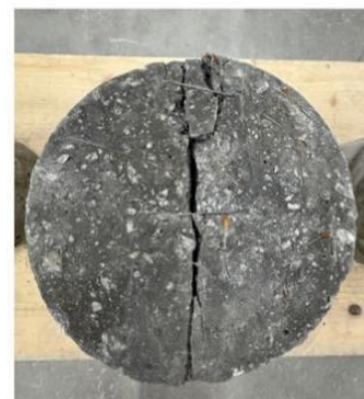
Abbildung 2.6.25: links: Mittelwerte der Spaltzugfestigkeiten der Mischungen StF+BF TB1–TB3 nach 28 Tagen, rechts: typisches Bruchbild eines Zylinders nach Spaltzugversuch
