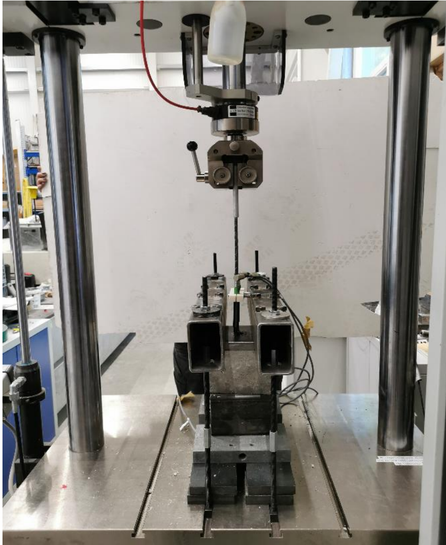
Abbildung 2.6.17: Aufbau des Pull-out-Tests (2)
