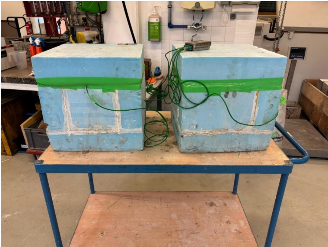
Abbildung 2.4.22: Temperaturmessung im isolierten Würfel
