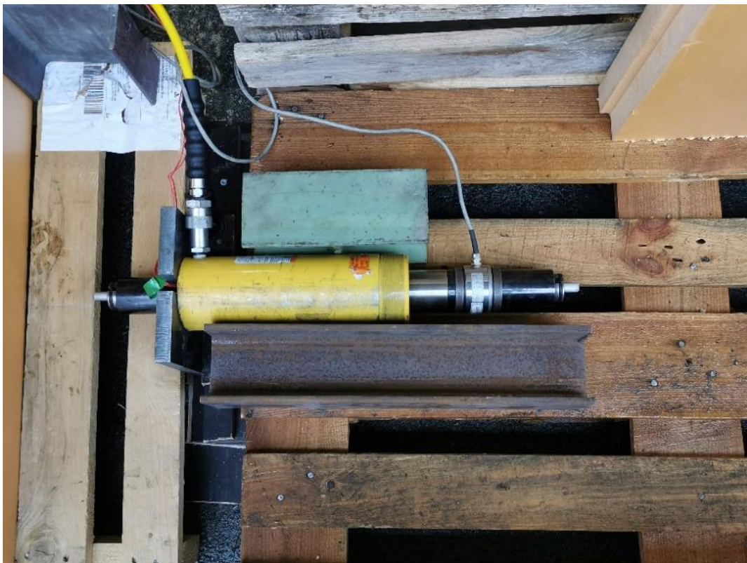
Abbildung 2.6.9: Aufbau des Zugversuchs
