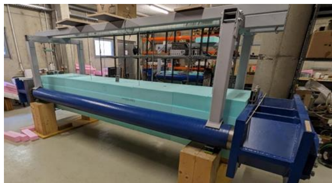
Abbildung 2.4.17: Zwangrahmenversuch, Isolierung nach dem Einbau
