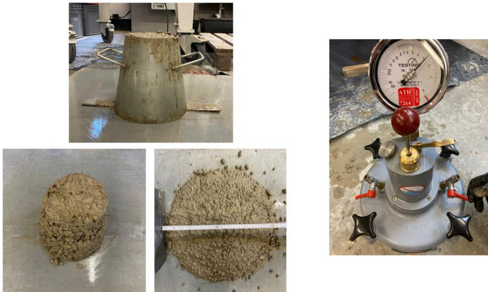
Abbildung 2.4.3: Abb. 14 Ausbreitmaßversuch der Fasercocktail-Mischung. Rechts: Luftporengehaltsversuch der Stahlfasermischung.
