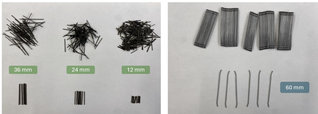
Abbildung 2.4.2: Abb. 13 Basaltfasern (Länge: 12, 24, 36 mm). Rechts: Stahlfasern (Länge: 60 mm) – verwendet zur Herstellung von faserverstärktem Beton im Rahmen des Projekts.
