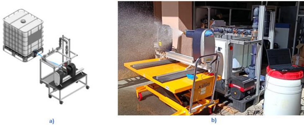
Abbildung 2.4.1: a) Messaufbau zur Bestimmung der Tröpfchengrößenverteilung; und b) Umgesetzter Aufbau (rechts) zur laseroptischen Messung von Tröpfchengrößen nach einer Düse
