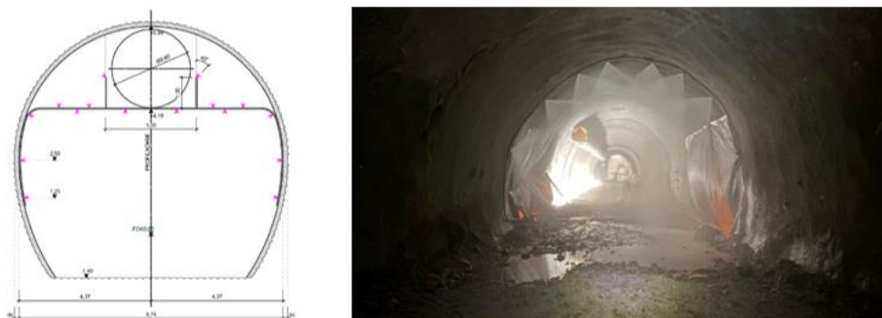
Abbildung 2.4.10: Schematische Düsenkranzauslegung für den BBT und umgesetzter Düsenkranz am ZaB
