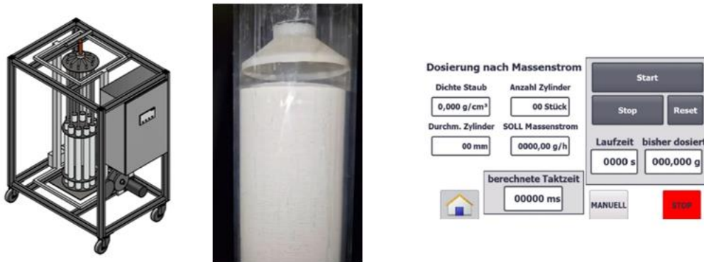
Abbildung 2.4.7: a) Dosieranlage, b) Dosierprinzip und c) Ausschnitt aus der Bedienoberfläche der Dosiersteuerung
