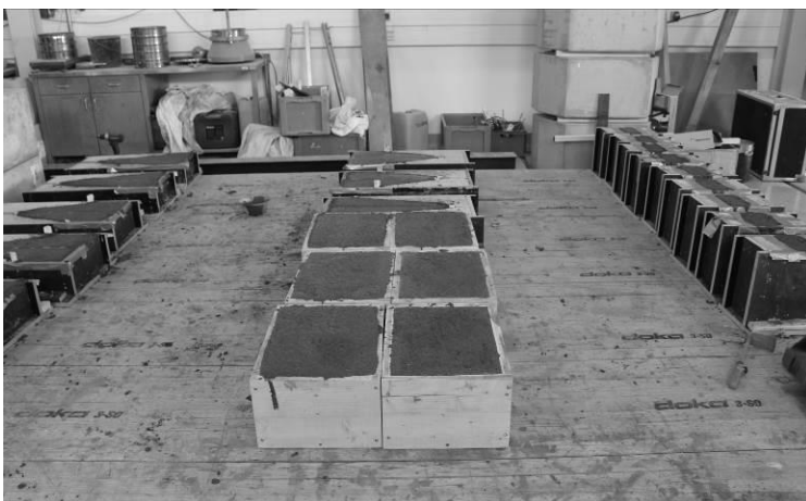
Abbildung 1: Versuchskörper nach Einbringen des Aufbetons
