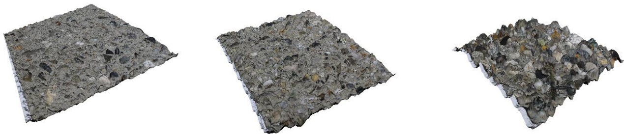
Abbildung 3: Oberflächenmodell der glatten (links), rauhen (Mitte) und verzahnten (rechts) Oberfläche
