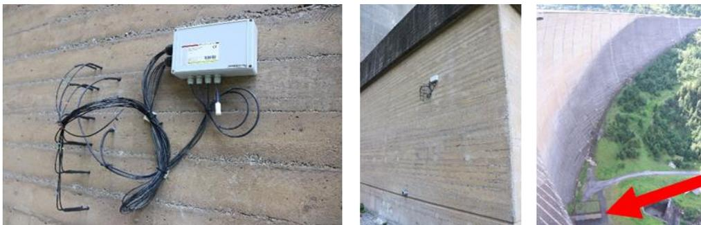
**Abbildung 17: Sensorinstallation am Staudamm Schlegeis**
